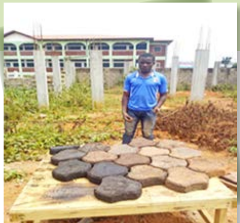
Activité de formation des jeunes sur la fabrication et la vente des pavés faits à base de bouteilles plastiques/ Activity of training of youths on the manufacturing of pavement with plastic bottles.
